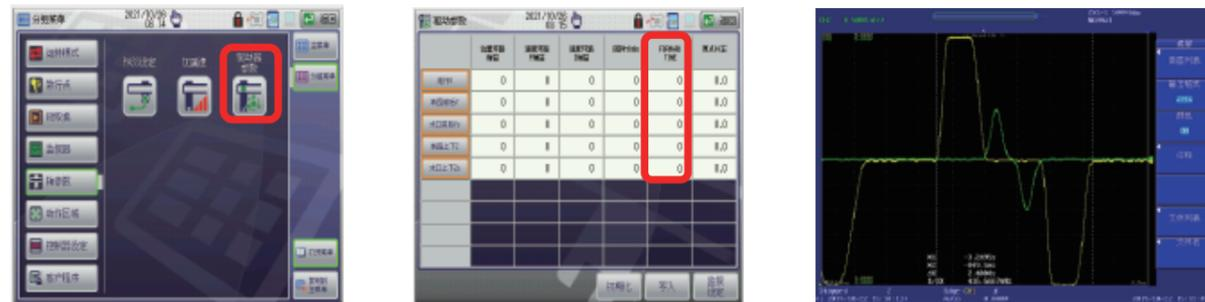
通过追加程序预判 (Forward Time) 功能，可以削减动作之间的时间。在插件等多点动作的程序中充分发挥效力。
