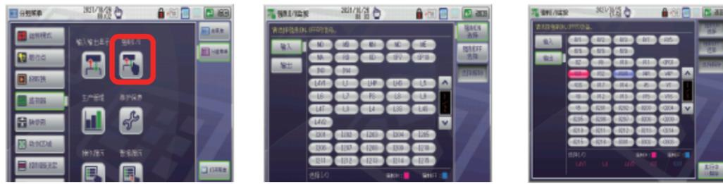
利用强制IO，可以对电磁阀等信号进行强制的ON/OFF操作，便于在没有实际设备时确认动作和程序，从而提升程序编辑以及问题查找的效率，并增加了安全提示功能。
